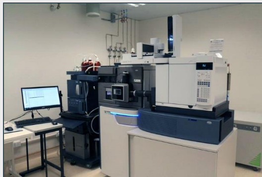
超高效液相及氣相色譜 高分辨離子淌度質譜儀 Waters SYNAPT G2-Si High Definition Mass Spectrometer
