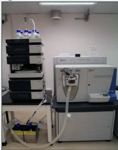
線性離子阱組合 靜電場軌道阱質譜儀 Thermo LTQ Orbitrap XL Mass Spectrometer
